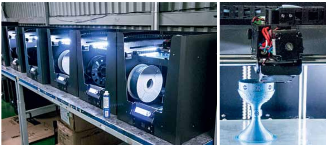
3D-принтеры. Слева: 24-часовой прогон. Справа: узоры на изделии – не ради красоты, а для подтверждения характеристик печати
