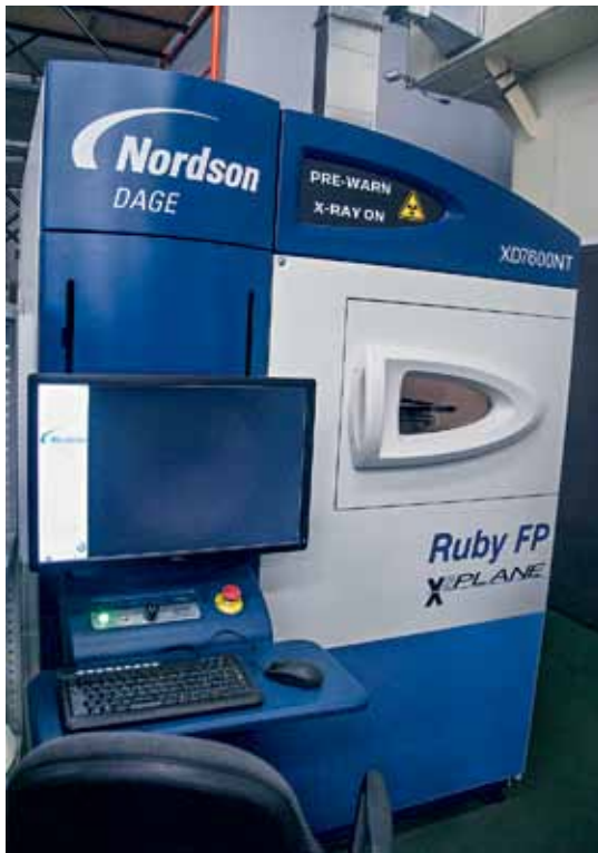
Установка рентгеновского контроля Ruby FP производства Nordson Dage
