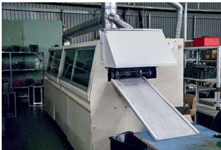
Установка пайки двойной волной ERSA N-WAVE-400F
