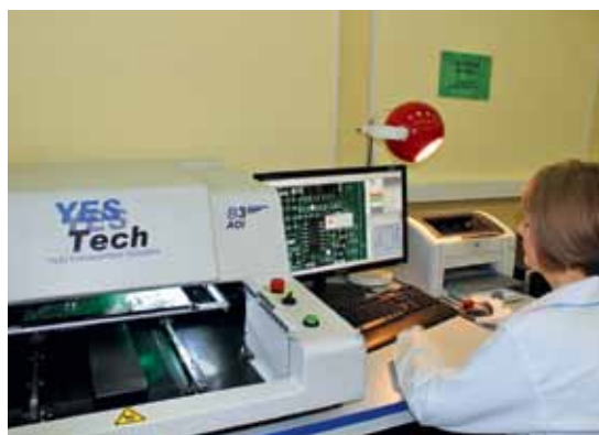
Установка АОИ YES Tech B3
