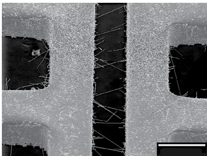
Рис.1. "Усы" олова на медной рамке, покрытой оловом, образовавшиеся в течение трех лет хранения [3]
