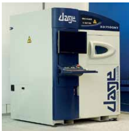
Установка рентгеновского контроля
