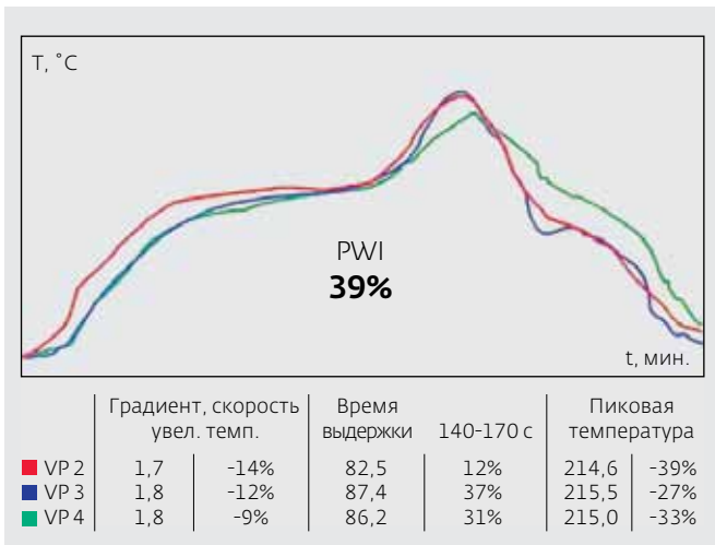
Рис.5. Профиль оплавления с индексом рабочего окна PWI=39%
