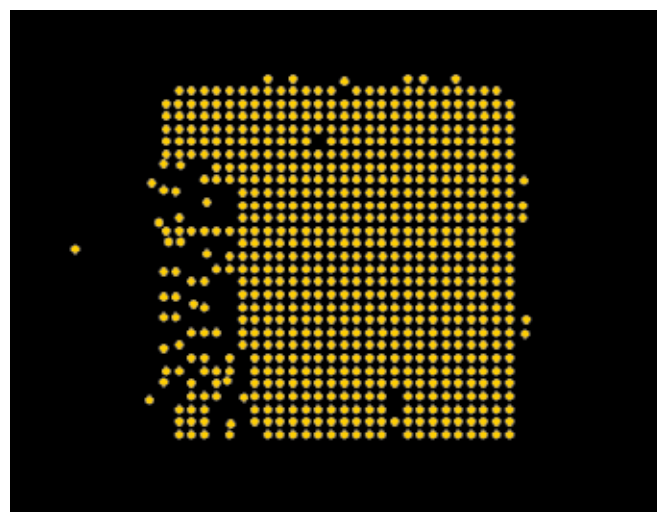
Рис.5. Фрагмент гербер-файла для заполнения переходных отверстий
