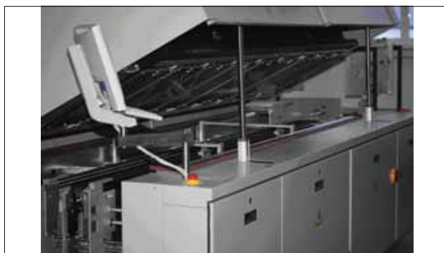
Рис.3. Процесс-камера печи оплавления
