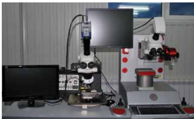
Рис.3. Оборудование для УЗ-разварки кристаллов и тестирования соединений
