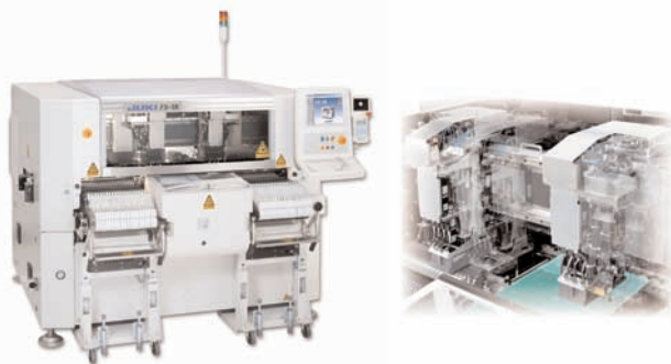
Автомат JUKI FX-1 (2 головки по 4 наконечника на каждой, линейный двигатель)
