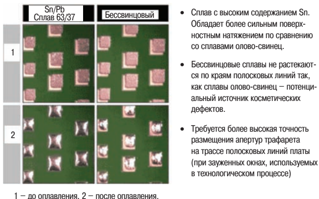
Рис. 1. Сравнение растекания припоя разного типа при оплавлении по контактным площадкам для монтажа компонентов в корпусах типа 0603 и 0805. (Фотография любезно представлена компанией Speedline Technologies.)
