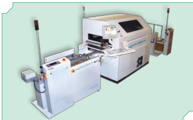
Рис.1 Система SPEA 4040 с автоматическими загрузчиком и разгрузчиком
