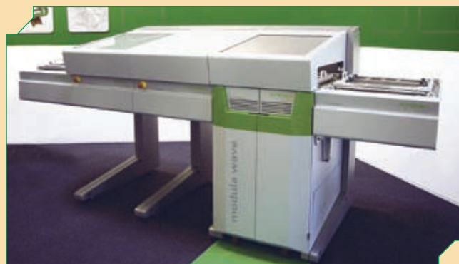
Установка нового поколения от компании Kirsten с "модульной волной" и горизонтальной конвейерной системой перемещения плат
