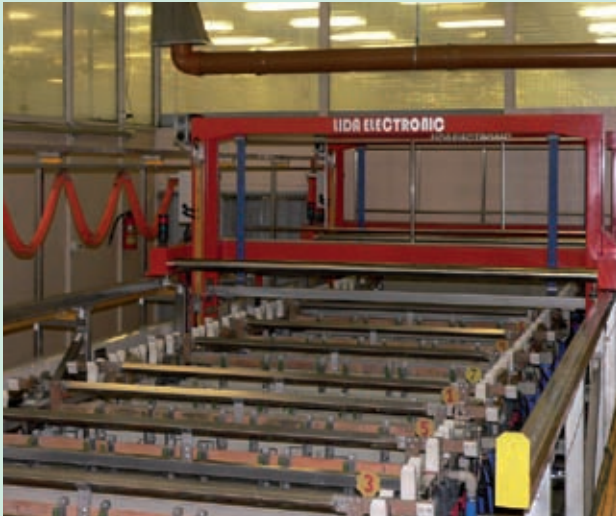
Рис.2 Автоматическая линия гальванического меднения (а) и щелочного травления с разгрузчиком плат (б)
