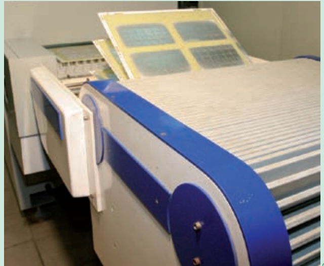
Рис.2 Автоматическая линия гальванического меднения (а) и щелочного травления с разгрузчиком плат (б)
