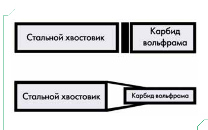
Рис. 1 Две конструкции сверл со стальным хвостовиком
