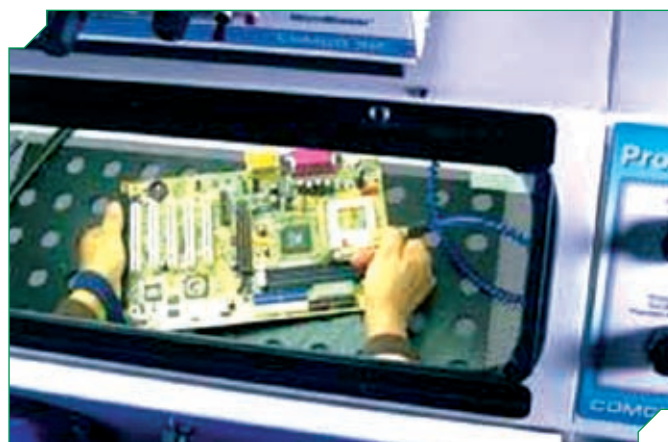
Рис. 1 Удаление конформного покрытия микроабразивом
