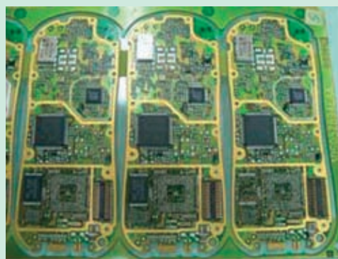
Рис. 1 Печатные узлы поверхностного монтажа с загрязнениями
