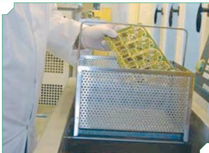
Рис.2 Очистка печатных узлов
