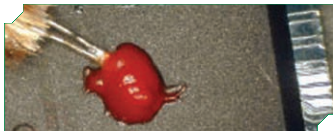
Рис. 1 Встроенная в корпус BGA термопара для измерения внутренней температуры
