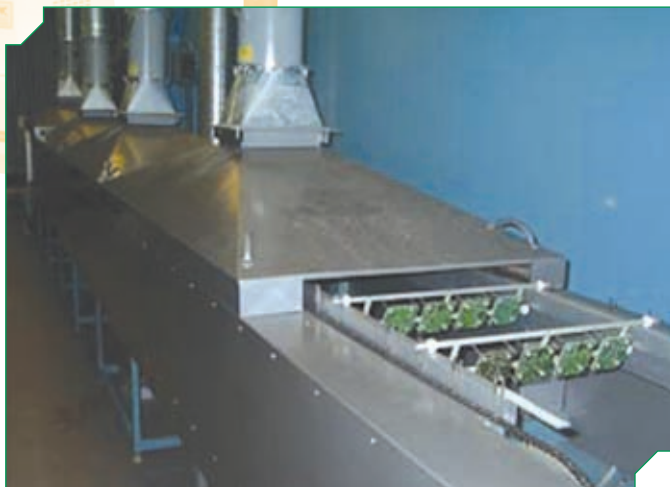
Рис.5 Печь конвейерная для сушки однокомпонентных лаковых покрытий
