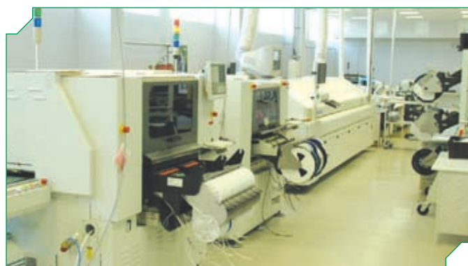
Рис. 1 Линия монтажа SMD-компонентов в ЗАО "Связь инжиниринг"
