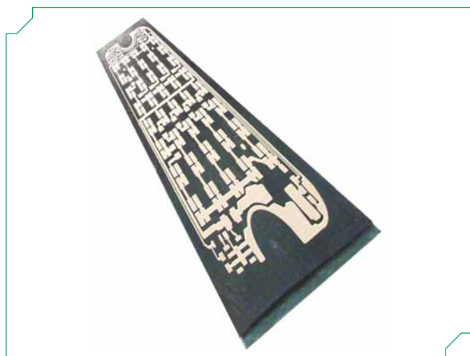
Рис. 8 ПП на основе материалов CoolPoly компании Cool Polymers
