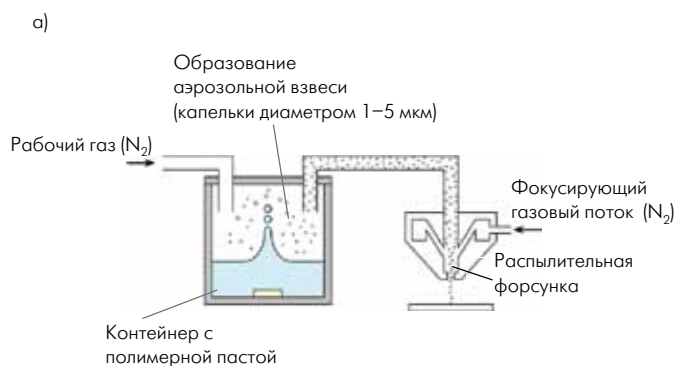
Рис.7. Технология напыления Aerosol Jet компании Optomec: а) схема установки, б) головка напыления
